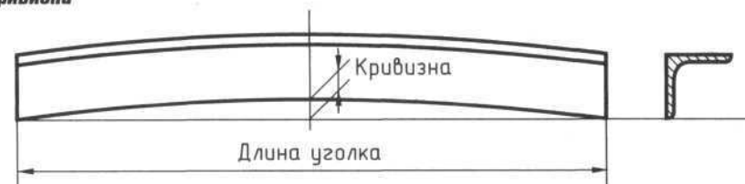
Рис. 2.34. Измерение кривизны уголка
