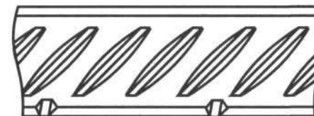
Рис. 2.69 а. Периодический профиль арматуры по ГОСТ 10884-94 с продольным выступом
